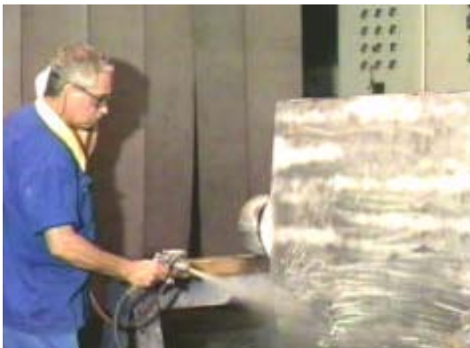
Aplicação do revelador por pulverização com pistola de pintura à esquerda e aplicação de revelador em aerosol, à direita.
