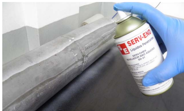
Aplicação do revelador por pulverização com pistola de pintura à esquerda e aplicação de revelador em aerosol, à direita.
